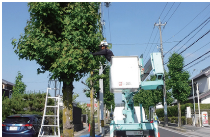
高所作業車を用いた高木の剪定
